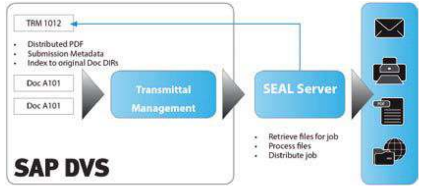
Ablauf des Generierungs- und Verteilungsprozesses von Transmittals unter Verwendung von SAP-Strukturdaten.
