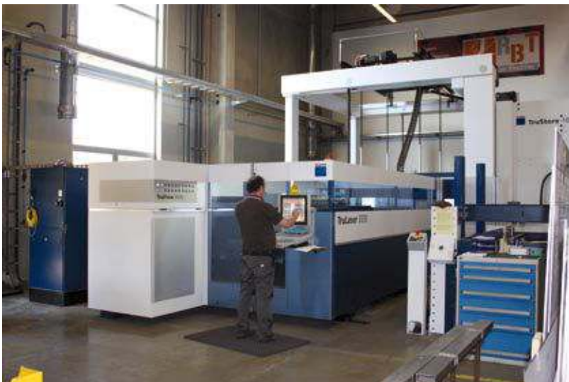
15 bis 20 Prozent Verschnitt sind bei Blechschneidemaschinen der Firma Rehm BlechTec nicht zu vermeiden.
