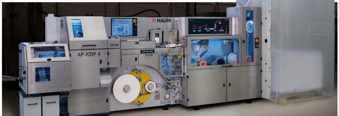
Die AF-KDF 4 baut die Filter für die Zigaretten als lange Stäbe – mit einer Geschwindigkeit von 6000 Filterstäben pro Minute.
