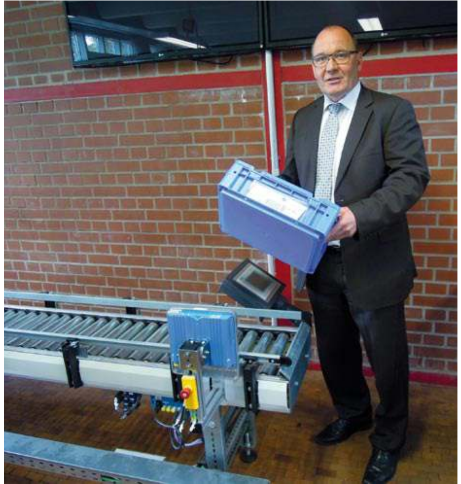
Unterschiedliche Steuerungssysteme können mit geeigneter Identifikationstechnologie sinnvoll gekoppelt werden. Im Demolabor des Kooperationspartners Qbing erfolgt die Zielvorgabe der mit Siemens Simatic gesteuerten Materialflussanlage durch eine vorgelagerte Verifizierung im ERP-System.
