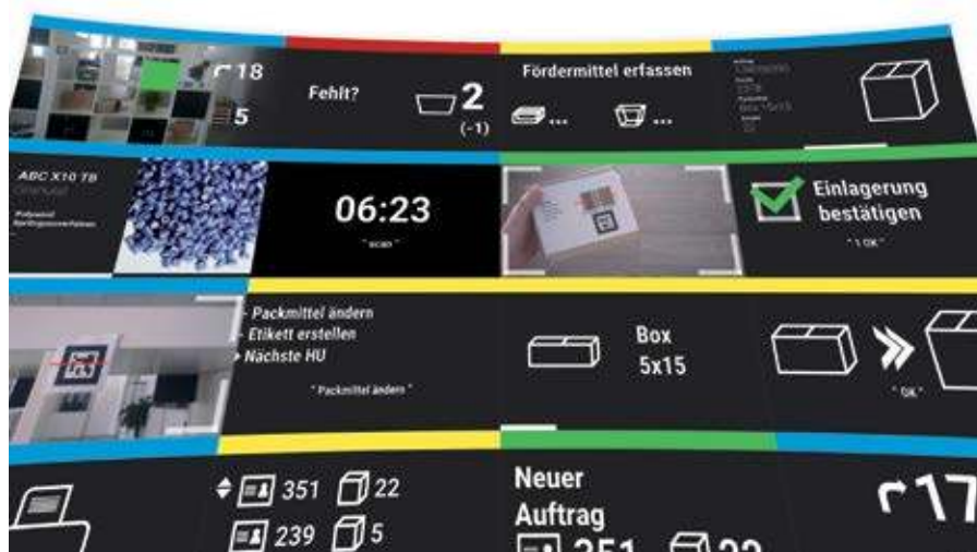
Die UI für Smart Glasses basiert auf einer Vielzahl flexibel entwickelter Karten. So kann der Kunde seinen Prozess individuell konfigurieren, ausrollen, testen und reevaluiieren.
